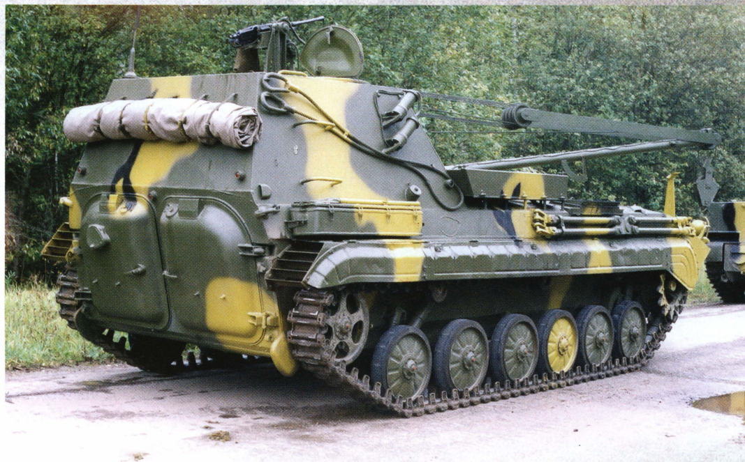
Ремонтная гусеничная машина РМ-Г «Десна», вид сзади справа. Хорошо видна установка 7,62-мм пулемета ПКТ.
