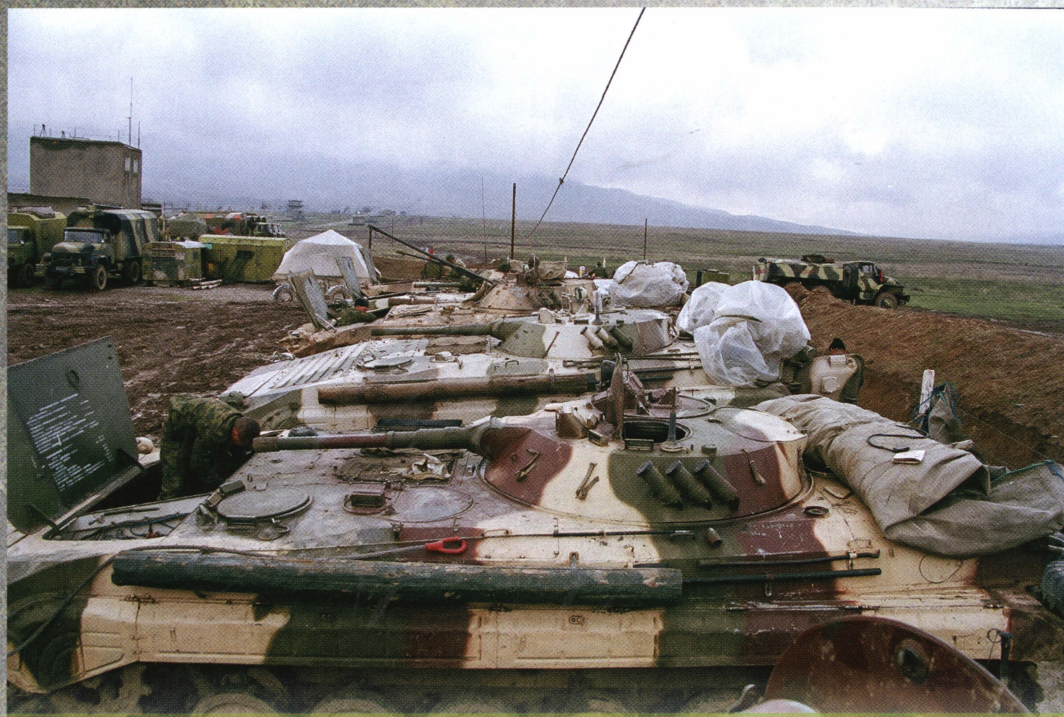
Командирская машина БМП-1К после маневров. Хорошо видна одна амбразура в задней части борта.
